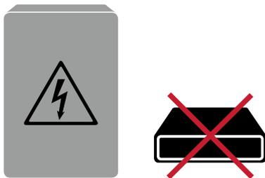
Modem nicht in der Nähe von Störquellen platzieren, wie z.B. Zentralheizung, Hausstromanschluss, Mikrowelle, Babyphone.
